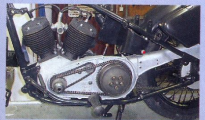
Solide: Primärtrieb per Duplexkette, eine zweite Kette treibt die Scintilla-Lima an
