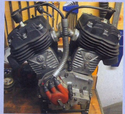
Als wär nix gewesen: Laufbahnen honen, Ventile einschleifen – mehr war nicht zu tun
