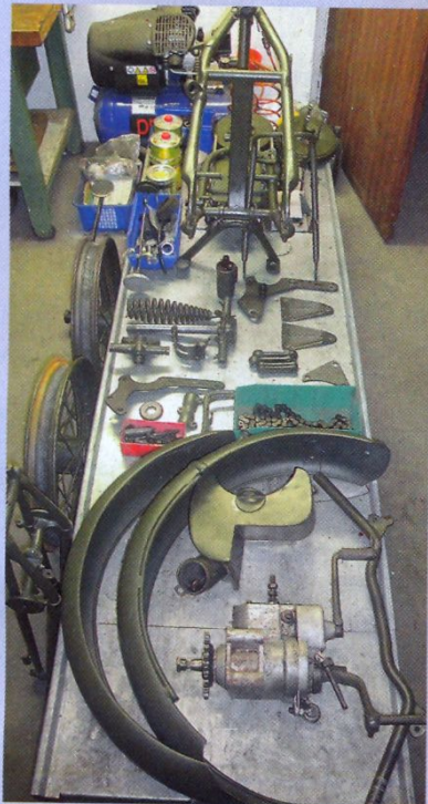
Keine Schweißarbeiten: Anbauteile wie die Schutzbleche bekamen nur neuen Lack
