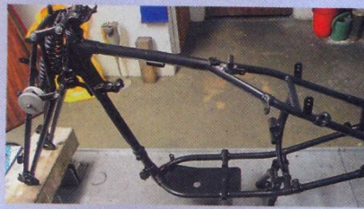
Schön zu erkennen: die massive Konstruktion des Rohrrahmens, der völlig intakt war
