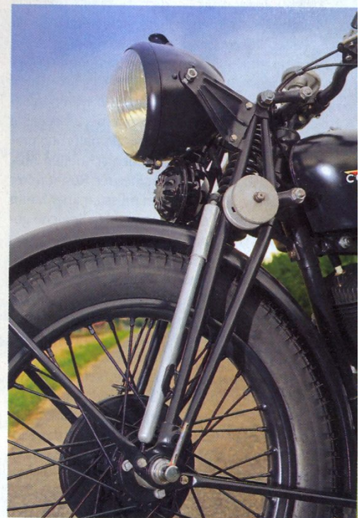
Verborgene Qualitäten: Steckachsen, sehr solide Gabel, Kegelrollenlager im Lenkkopf
