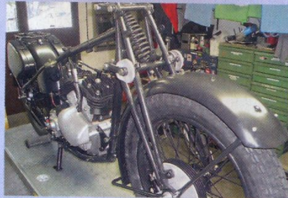
Keine Schweißarbeiten: Anbauteile wie die Schutzbleche bekamen nur neuen Lack
