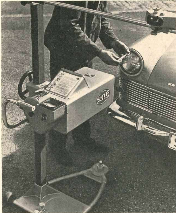
Bild 13 Hella-Scheinwerfereinstellgerät mit Visiereinrichtung, Luxmeter und einstellbarem Bildschirm
