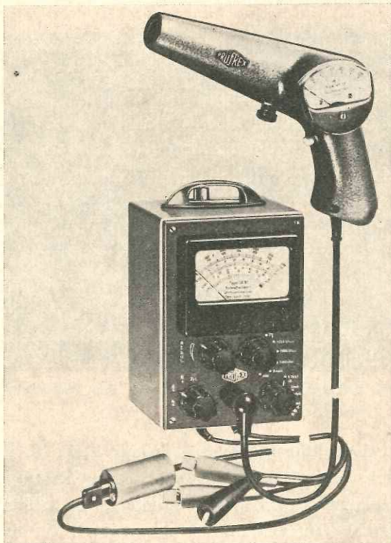
Bild 78 Der Prüfreflex-Tester SD 17/VP 17 «S» ist eine Kombination von Drehzahlmesser, Schließwinkelmesser und Zündlichtpistole mit einer Verstellwinkel-Anzeige bis 60 Grad
