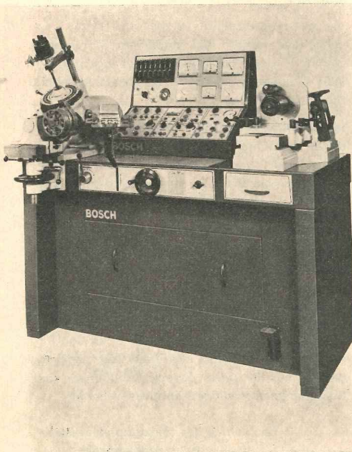
Bild 1 Bosch-Kombinations-Prüfstand EFAW 240 für Starter, Generatoren und Zündanlagen
