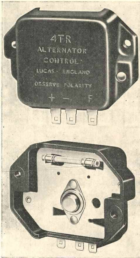
Bild 80 Lucas-Volltransistor-Regler für Drehstromgeneratoren.
